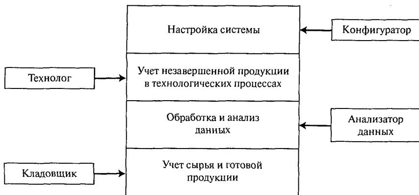
Рис. 6.4. Использование автоматизированной системы учета товарно-материальных ценностей в технологических процессах
