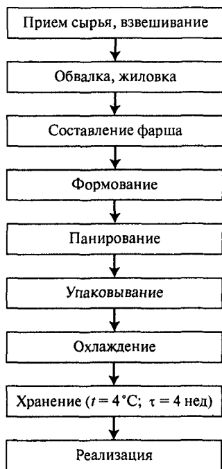
Рис. 3.18. Технологическая схема производства рубленых полуфабрикатов
