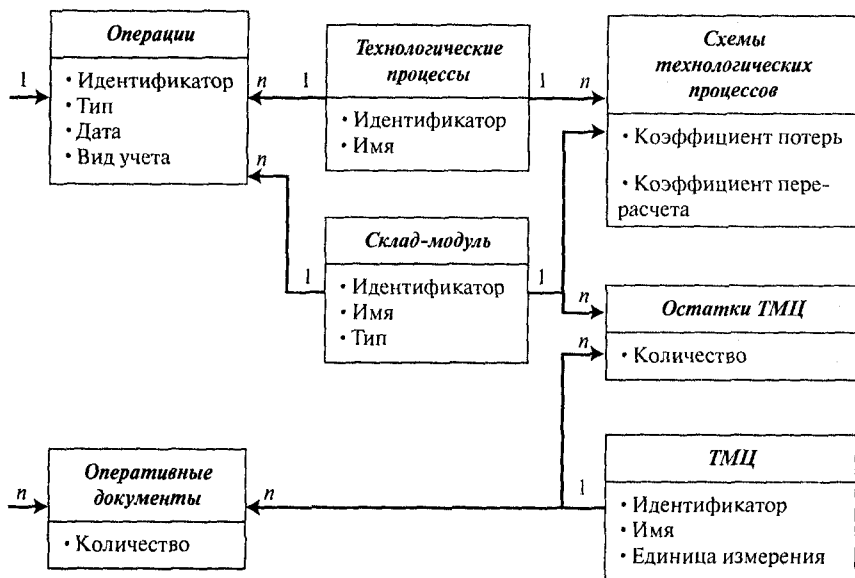
Рис. 6.6. Фрагмент ER-диаграммы автоматизированной системы учета ТМЦ в технологических процессах
