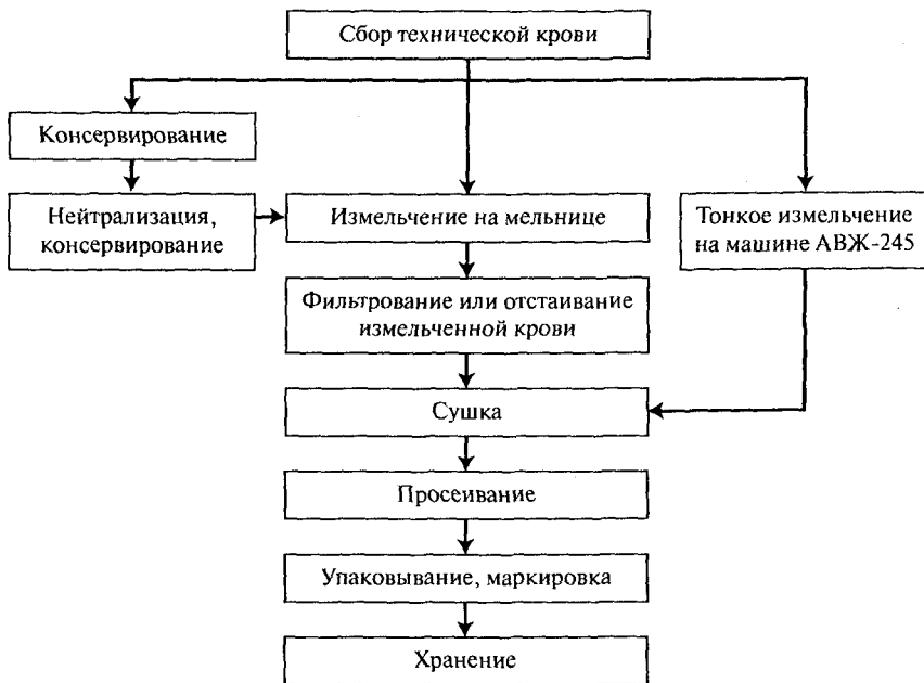
Рис. 3.14. Технологическая схема получения черного технического альбумина
