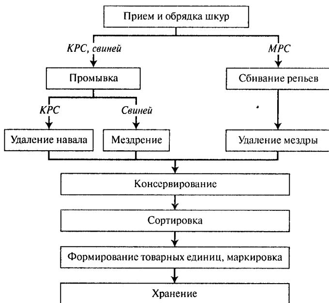
Рис. 3.11. Технологическая схема обработки шкур
